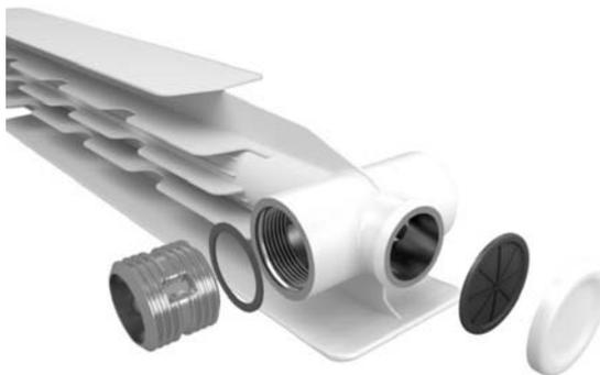
Наиболее прогрессивным способом закрытия отверстия коллектора является метод вальцевания. Стальная заглушка с усиленной нанополимерной мембраной надевается на отверстие коллектора по принципу закатывания банок, примерно так же, как делаются консервы на зиму. Это обеспечивает абсолютную герметичность и надежность радиатора даже при работе в экстремальных условиях.
