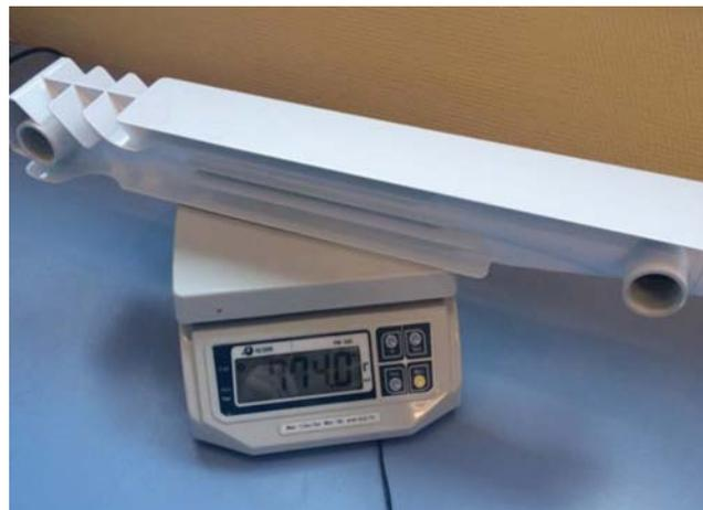
Следующий важный критерий при выборе радиатора отопления – вес секции. Это относится как к алюминиевым, так и биметаллическим радиаторам. Чем он больше, тем выше теплоотдача прибора. Вес алюминиевой секции радиатора, как правило, колеблется от 1000 до 1250 г. Секция биметаллического радиатора тяжелее и составляет 1800–2000 г.
